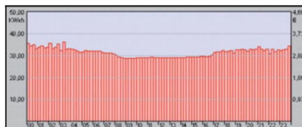
Figura 8. Gasto cuartohorario de la soplante rotativa.
