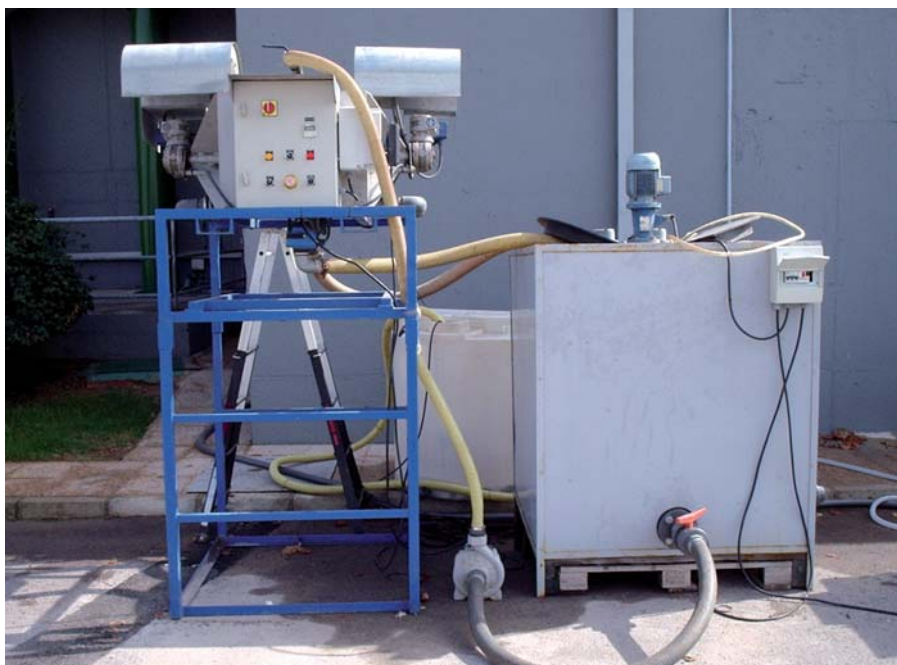
Figura 2. Dispositivo experimental empleado. Planta piloto del Sistema de Filtración MD junto a tanque agitado y bomba de alimentación.
