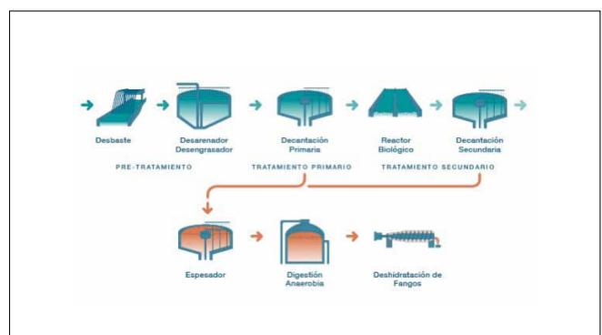
Figura 2. Esquema general del tratamiento de lodos en EDAR.
