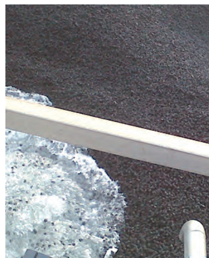
Figura 3. Mezclado inicial de carriers en un reactor
